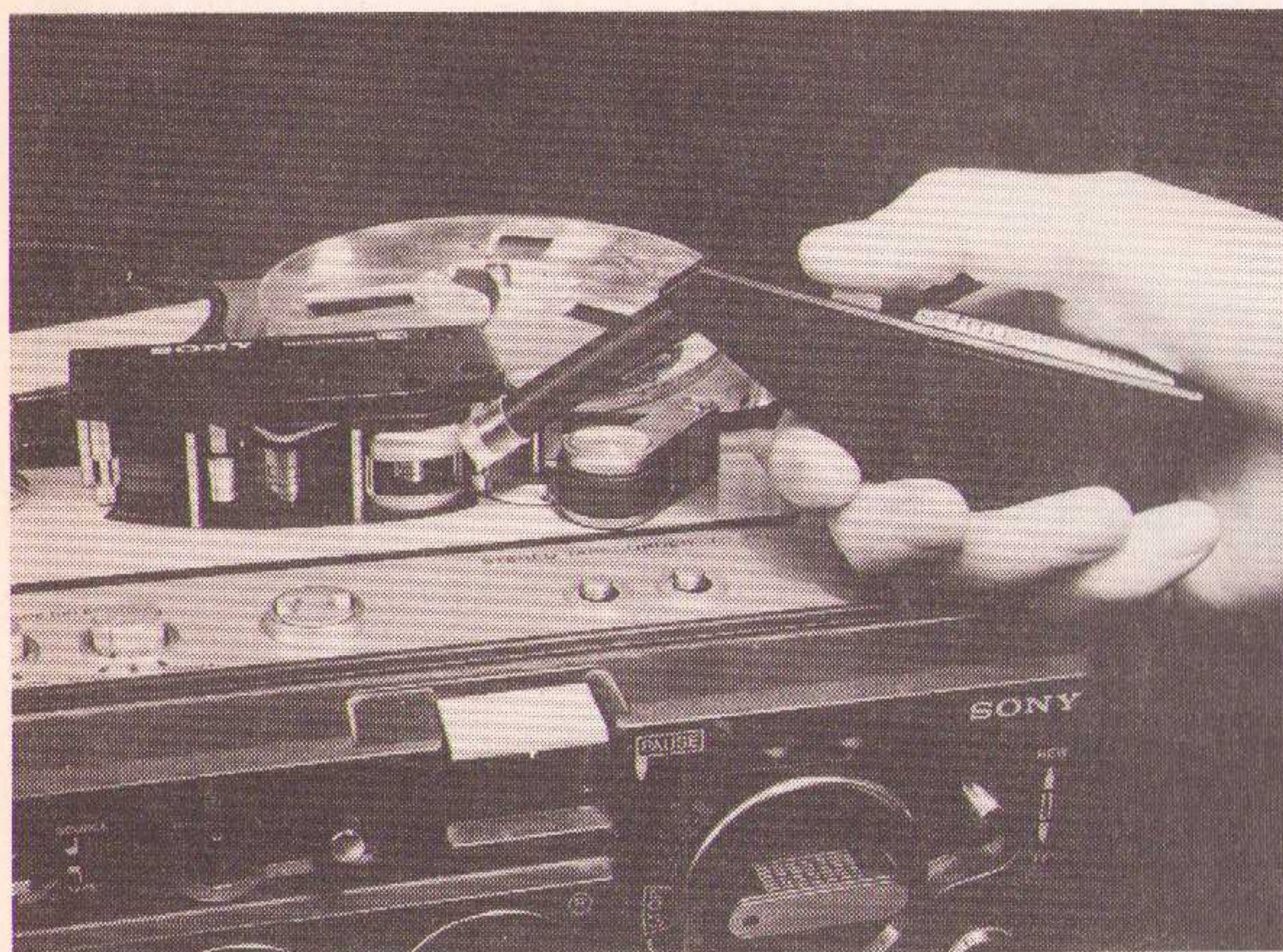
Foto 2. De batterijgevoede kopdemagnetiseur van AM in bedrijf.
